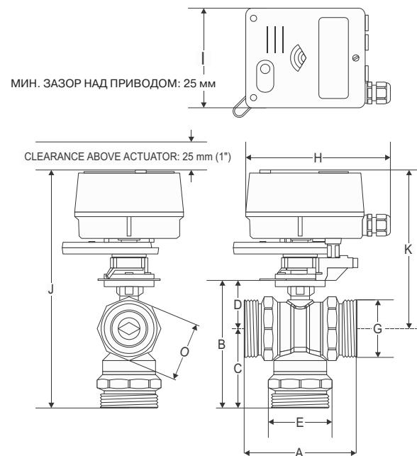
КЛАПАН VBG2 С ЭЛЕТРОПРИВОДОМ M6061/M7061
