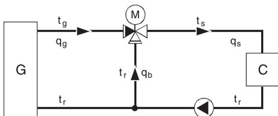
Рис. 24: Расчет утечки с использованием температурного метода
