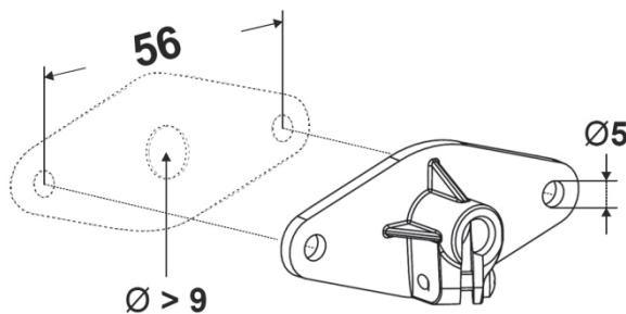
Рис. 2. Габаритные размеры монтажного фланца в мм
