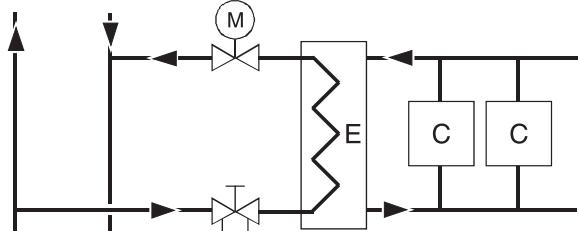
Рис.15 Система отопления, подключенная к системе централизованного теплоснабжения
