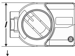
МИН. ЗАЗОР НАД ПРИВОДОМ: 19 мм
