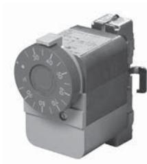
Аквастаты L6190 являются высокочувствительными водяными термостатами, разработанным для монтажа на поверхности труб отопления или горячего водоснабжения. Функция переключения SPDT выполняется при помощи быстродействующего микропереключателя, приводимого в движение датчиком температуры.
