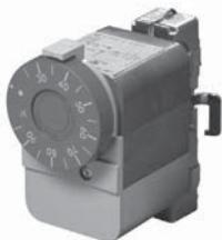
Аквастаты L6190 являются высокочувствительным водяными термостатами, разработанным для монтажа на поверхности труб отопления или горячего водоснабжения. Функция переключения SPDT выполняется при помощи быстродействующего микропереключателя, приводимого в движение датчиком температуры.
