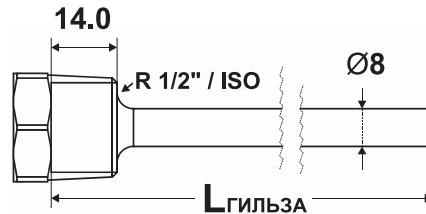
Рис. 2. Габаритные размеры погружной гильзы в мм
