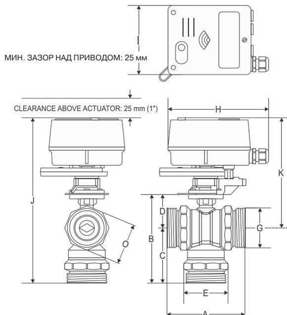
КЛАПАН VBГ2 С ЭЛЕКТРОПРИВОДОМ M6061/M7061
