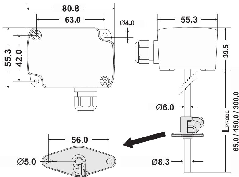
Рис. 1. Габаритные размеры датчика температуры в мм
