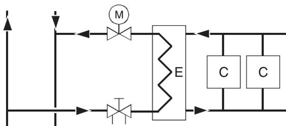
Рис. 15 Система отопления, подключенная к системе централизованного теплоснабжения
