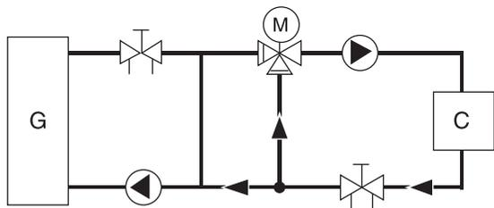
Рис. 12: Радиаторный контур подключенный к котельной тепловой установке
