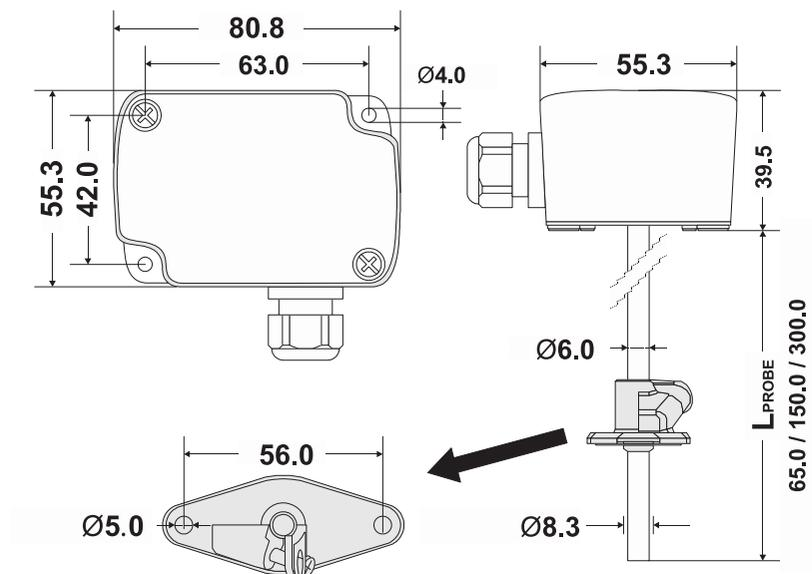
Рис. 1. Габаритные размеры датчика температуры в мм
