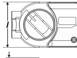
МИН. ЗАЗОР НАД ПРИВОДОМ: 19 мм
