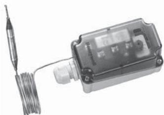
Термостаты серии FT69 предназначены для использования в качестве термостатов защиты от замерзания и обеспечения защиты расположенных за ними калориферов в системах вентиляции и кондиционирования воздуха, а также теплообменников в системах охлаждения. Могут также использоваться для управления электрическими системами нагрева и включения акустических или оптических сигнальных систем.
