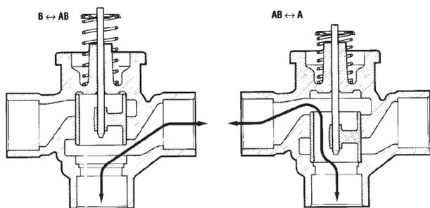
Если привод не установлен на клапан, то пружина поддерживает клапан в нормально-закрытом состоянии для 2-ходового клапана, а для 3-ходового клапана – А-АВ закрыт (В-АВ открыт).
