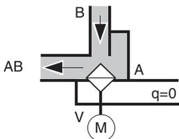
Рис. 5: 3-х ходовой клапан с открытым портом В
