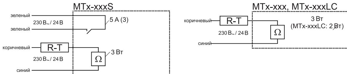
Модель с концевым выключателем
