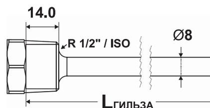
Рис. 2. Габаритные размеры погружной гильзы в мм
