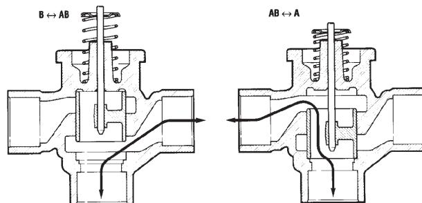
Если привод не установлен на клапан, то пружина поддерживает клапан в нормально-закрытом состоянии для 2-ходового клапана, а для 3-ходового клапана – А-АВ закрыт (В-АВ открыт).
