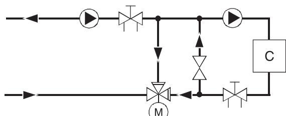
Рис. 13: Система с постоянным расходом в первичном и вторичном контуре
