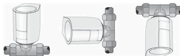
Предпочтительно устанавливать привод на клапан вертикально или горизонтально.
