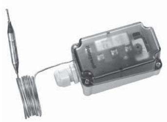
Термостаты серии FT69 предназначены для использования в качестве термостатов защиты от замерзания и обеспечения защиты расположенных за ними калориферов в системах вентиляции и кондиционирования воздуха, а также теплообменников в системах охлаждения. Могут также использоваться для управления электрическими системами нагрева и включения акустических или оптических сигнальных систем.
