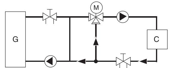
Рис. 12: Радиаторный контур подключенный к котельной тепловой установкой
