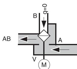
Рис. 4: 3-х ходовой клапан с открытым портом А
