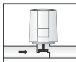
Управляющее напряжение отсутствует - клапан закрыт
