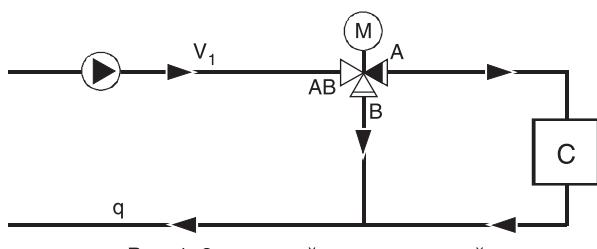
Рис. 1: 3-х ходовой разделительный клапан
