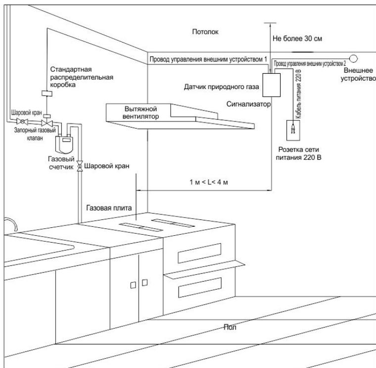
При потолочном монтаже сигнализатор следует установить на расстоянии не более 4 м от газового прибора.
