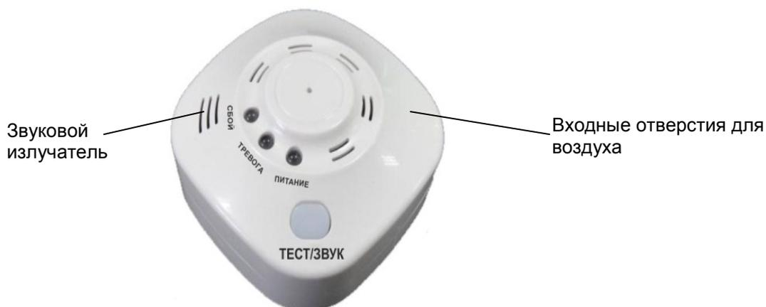
Сигнализатор следует установить в месте наиболее вероятного скопления газа, на стене в вертикальном положении, на расстоянии 0,3 м от потолка. Расстояние между установленным на стене сигнализатором и газовым прибором не должно превышать 4 м. Место установки и схема подключения показаны ниже.
