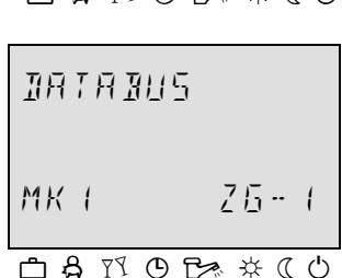
После того, как SDW30N впервые подключен к bus-системе, задается его адрес, учитывая отопительный контур, к которому он относится.
