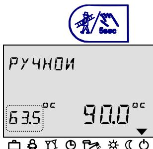
Контроллер переключится в "Ручной режим" / "Измерение загрязнений", если соответствующую кнопку удерживать нажатой более 5 секунд, когда отображается основной экран. В этом режиме температура котловой воды выставляется вручную путем поворота поворотно-нажимной кнопки.
