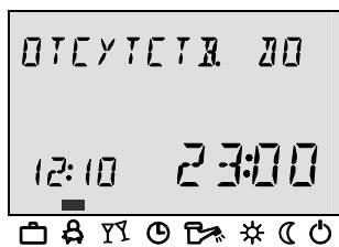
При использовании этого режима, отопление может быть временно отключено на **короткий** промежуток времени (в течение суток). В период отсутствия все отопительные контуры контролируются в соответствии с экономичной уставкой температуры в комнате.
